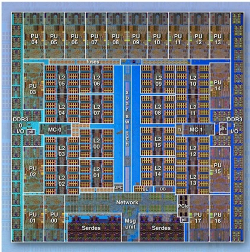
**Figure 3:** The BlueGene/Q compute chip die photo
